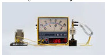
Konstantanový drát délky l/2 s dvojnásobným průřezem
