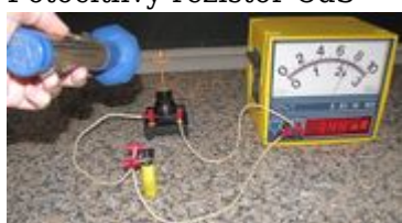
Hodnoty procházejícího proudu po osvětlení fotocitlivého rezistoru baterkou
