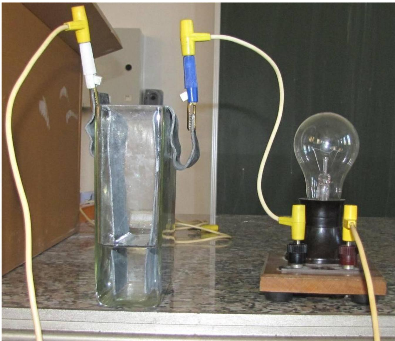
V tomto experimentu demonstrujeme vodivosť a nevodivosť destilovaného vody, cukerného roztoku, solného roztoku a vody z kohoutku.
