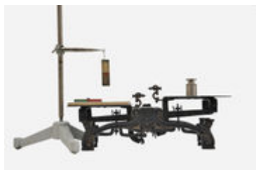
Rozvážení vah odpudivou silou
