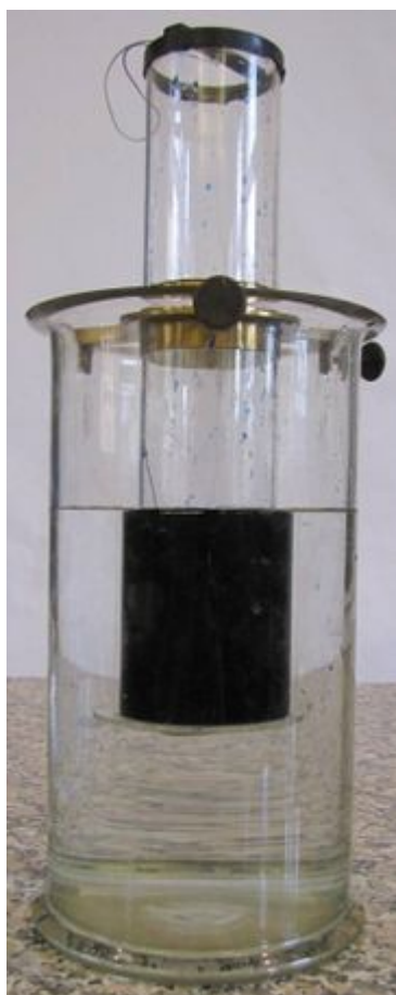
Nádoba s odpadávajícím dnem naplněná obarvenou vodou
