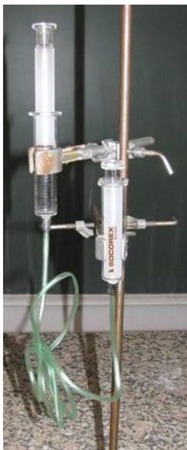
Model pístu pomocí injekčních stříkaček
